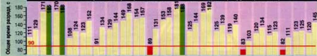
Рис.4 Результаты проверки стартерных свойств батарей при заявленных токах и температуре -30°C
