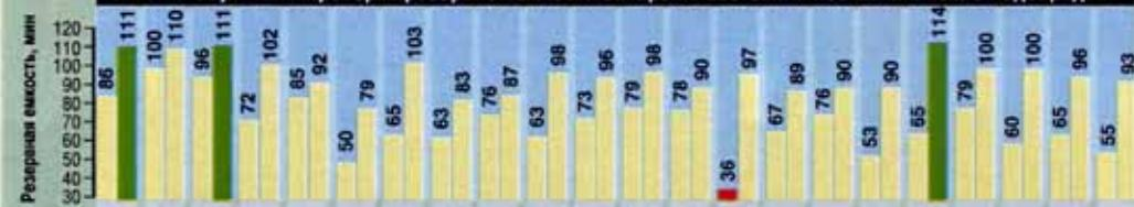
Рис.2 Результаты проверки стартерных свойств батарей при температуре -18°C и едином токе 450 А
